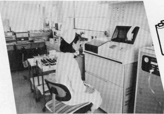
血液からあなたの健康をチェック。自動化学分析装置(右)と自動血球計数装置。
