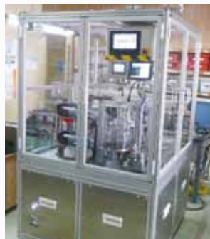
熱電対素線自動溶接3号機
