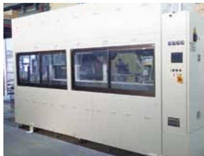
▲4槽直振動式自動超音波洗浄機
