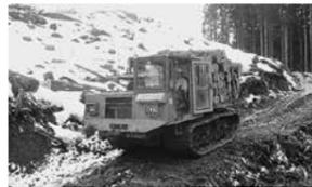
クローラによる丸太搬出作業
