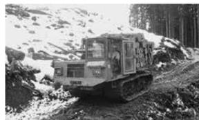
クローラによる丸太搬出作業
