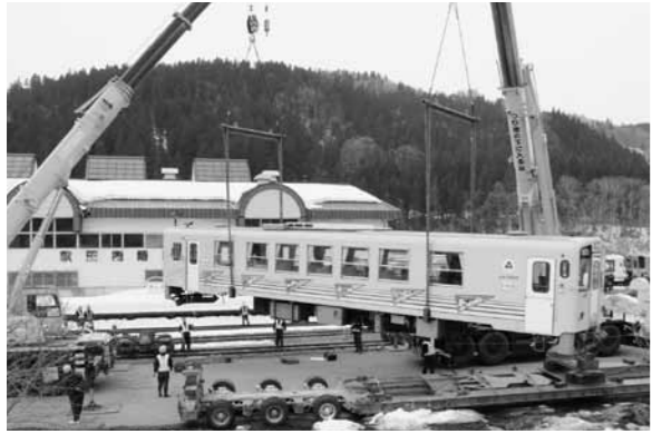
▲2台のクレーン車を使ってつり上げられる秋田内陸線車両
